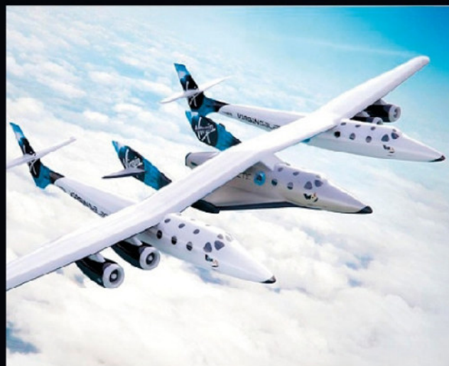
Das Dreiergespann: In der Mitte befindet sich die Rakete, die vom Trägerflugzeug auf Starthöhe gebracht wird. Nach dem Launch der Rakete fliegt das Trägerflugzeug "allein" zurück zur Erde.
